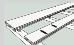
Schieben Sie sanft die zweite Diele gegen alle Clips und stellen Sie sicher, dass alle Clips in die seitliche Nut der zweiten Diele passen.
