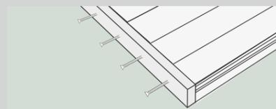
Falls Sie ein Abschlussprofil an die Dielenenden montieren müssen, setzen Sie zunächst die Vorbohrung durch das Abschlussprofil in die Dielseite oder Unterkonstruktion, sodass das Abschlussprofil bündig mit der Dielenoberseite verschraubt werden kann.
