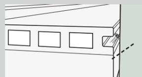
Bei der letzten Diele setzen Sie Aufnahmebohrungen in einem Winkel von 45° zwischen die Nutwangen am Rand der Diele in die Mitte der Unterkonstruktion. Schrauben Sie die Diele fest.
