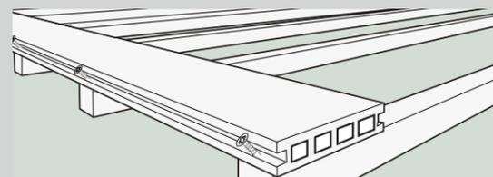
Befestigen Sie die erste Diele auf der Anfangsposition. Setzen Sie Aufnahmebohrungen in einem Winkel von 45° zwischen die Nutwangen am Rand der Diele in die Mitte der Unterkonstruktion. Schrauben Sie die Diele fest. Die Dielen sollten in Längsrichtung ein Gefälle von 1% (1 cm/m) aufweisen.
