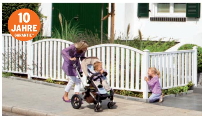
**LONGLIFE CLEO (Fensterkunststoff, Weiß):** Elementbreite 180 cm, Mittelhöhe 85 bzw. 102 cm. Profile 28,5 x 82,5 mm, Holme 40 x 50 mm. Ergänzen Sie LONGLIFE CLEO zum Beispiel durch moderne Aufsatzleisten aus Aluminium.
